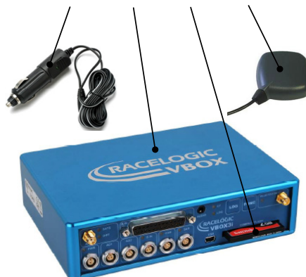
Фиг. 2. VIBOX 3i: 1- Захранващ кабел; 2-GPS модул; 3-SD карта; 4- GPS антена
