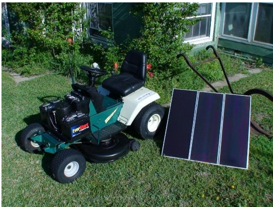
Фиг. 5. Общ вид на Batt Mower със слънчевия модул за зареждане [7]
